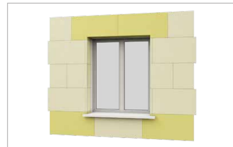
Правильное расположение панелей по периметру проемов
