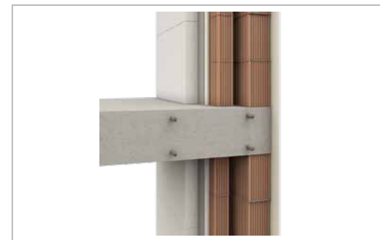
Стратиграфическое представление конструкции с внутренней теплоизоляцией
