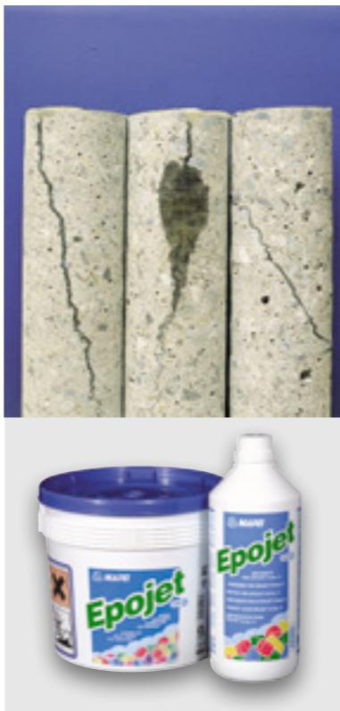
или Adesilex PG4; для ремонта трещин в стяжках заливкой, под действием силы тяжести и для установки металлических анкеров в бетоне.
